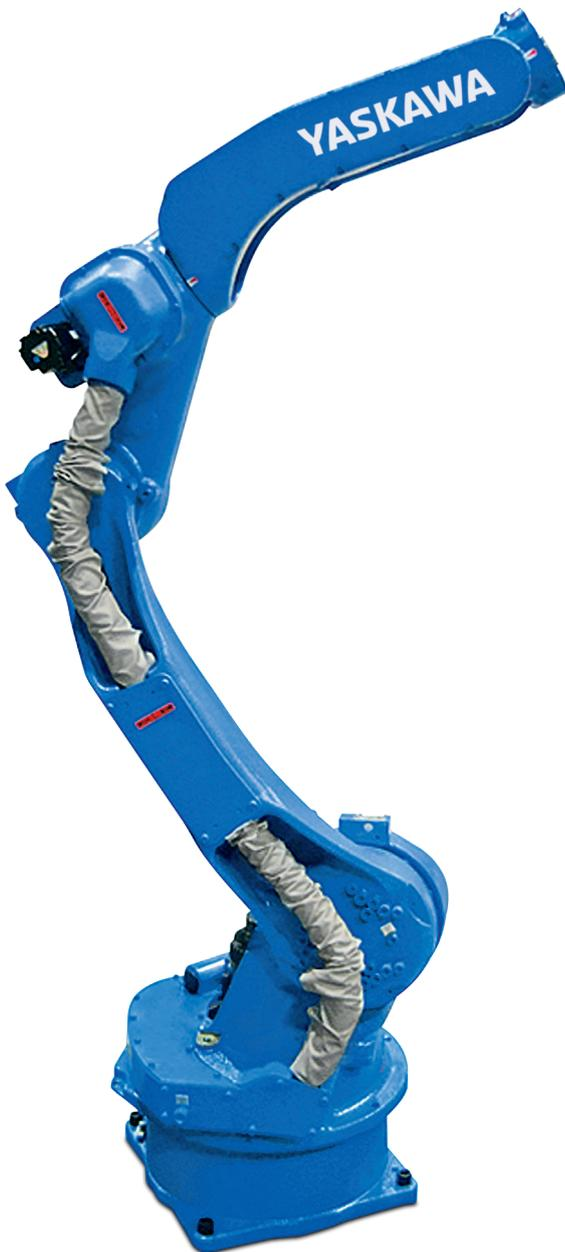
Der 6-achsige Hochgeschwindigkeits-Roboter MOTOMAN MH24 von YASKAWA bietet Höchstleistungen in einer Vielzahl von Anwendungsbereichen, wie z.B. Handling oder Maschinenbestückung. Die hohle Struktur des oberen Arms (Durchmesser 50 mm) dieses Universalroboters ermöglicht die interne Medienführung, wodurch Störkonturen verringert und die Lebenszeit des Schlauchpaketes verlängert wird. Trotz hohler Konstruktion wurde die Außenkontur des Oberarms nur gering verändert.
